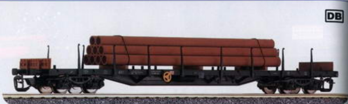
15534 Containertragwagen Rgs der DB AG mit Rohladung Container wagon Rgs of the DB AG, loaded with pipes
