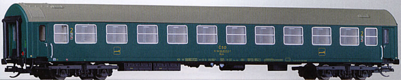
Liegewagen 2. Klasse, Typ Y, der ČSD 2nd class couchette coach, type Y, of the ČSD
