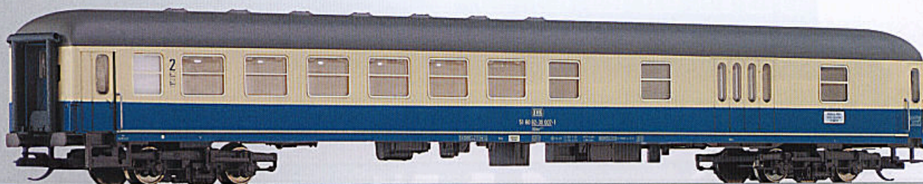
Reisezugwagen BDms 273, kombinierter Sitz- und Gepäckwagen der DB Passenger coach BDms 273, combined seating/baggage waggon of the DB
