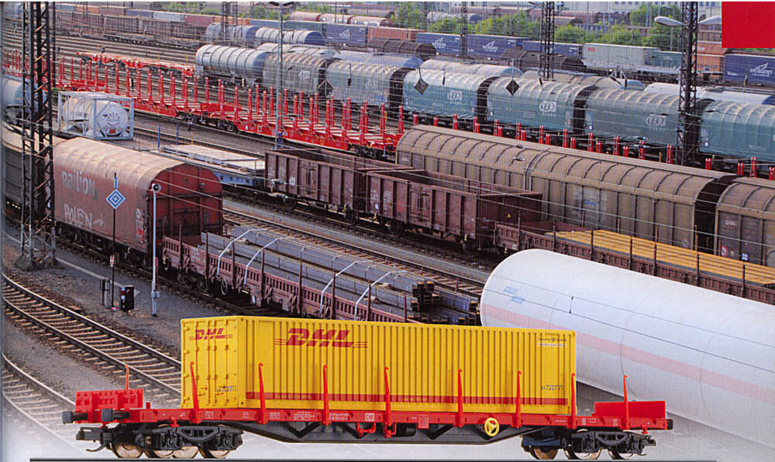
Containertragwagen Rgs-w 672 der DB AG, beladen mit 40"- Container „DHL“ Container car Rgs-w 672 of the DB AG, loaded with 40" container „DHL“
