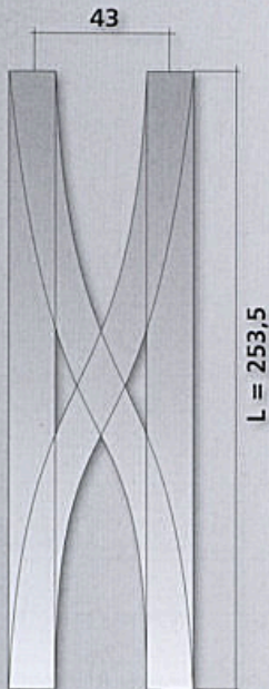
DGV 30°, Herzstückwinkel Weichen 15° DGV 30°, frog angle 15°
