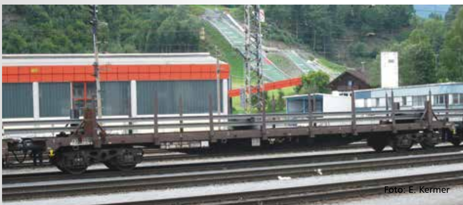
Rungenwagen Rs der ÖBB, beladen mit Schienen Stake car Rs of the ÖBB loaded with tracks
