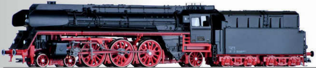
Dampflokomotive BR 01.5 der DR Steam locomotive class 01.5 of the DR • Mit Boxpok-Treibradsätzen und Öltender
