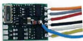
Decoder Gold mini + zum Anschluss über Kabel Gold mini + decoder to connection via soldering (11 x 9 x 2,6)*
