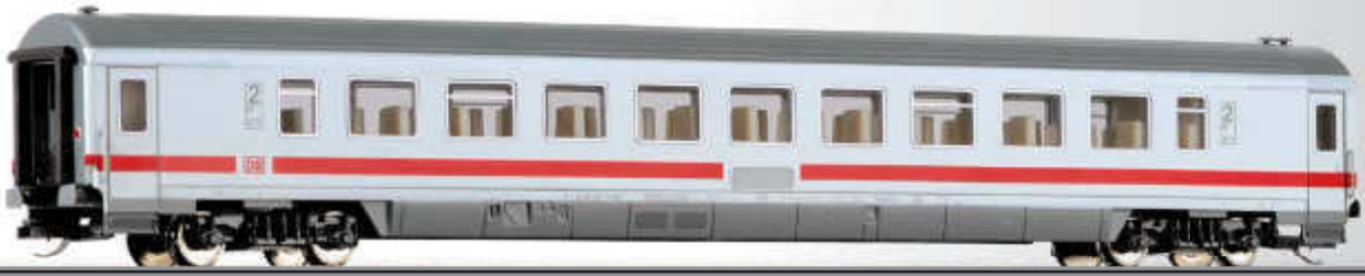
Reisezugwagen 2. Klasse Bpmz 291 der DB AG 2nd class passenger coach Bpmz 291 of the DB AG
