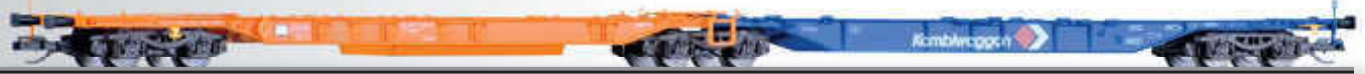
Doppeltragwagen Sdgggnos/Sdggmrs 739 / 744 „Kombiwaggon“ der DB AG Container car Sdgggnos/Sdggmrs 739/344 „Kombiwaggon“ of the DB AG
