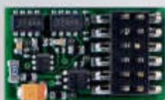
Decoder PluX12 NEM 658 (außer BR 189, TRAXX, Taurus) Decoder PluX12, NEM 658 (14,7 x 8,6 x 2,4)*
