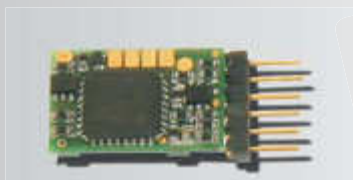
Funktionsdecoder decoder (11 x 8 x 2,4)*
