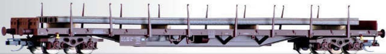
Rungenwagen Rs der ÖBB, beladen mit Schienen Stake car Rs of the ÖBB loaded with tracks
