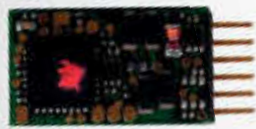
Decoder mit Stecker NEM 651 decoder to connection via plugs (14,9 x 8,6 x 2,4)*
