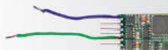
Digitaldecoder CT Elektronik DCX74D, ermöglicht zusätzliche Lichtfunktion für VT137, V60.10-11, Desiro BR 642 Decoder CT Electronic CX74D, enables additional light functions VT137, V60.10-11, Rail car class 642 (13 x 9 x 1,5)*
