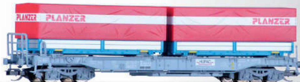
Taschenwagen der HUPAC, beladen mit zwei Wechselpritschen „PLANZER“ Pocket wagon of the HUPAC with load
