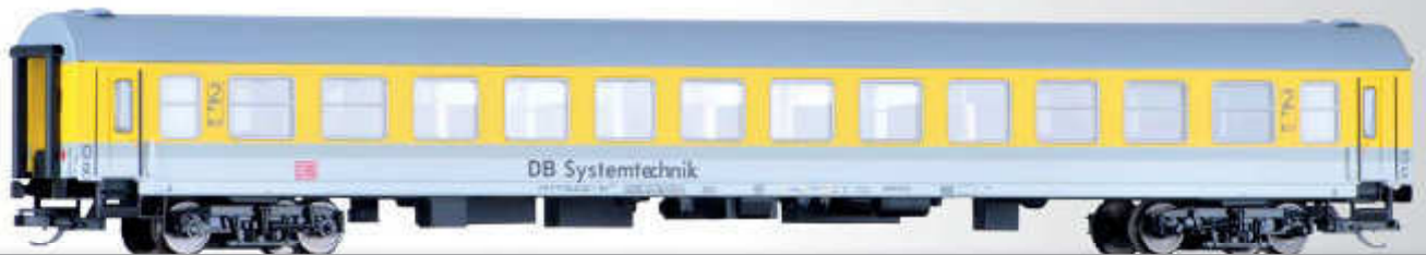
Wagenset „DB Systemtechnik“ der DB AG, bestehend aus zwei Messbeiwagen (1 x Bimz 259.8 Bauart Halberstadt, 1 x Bim 547.5 m-Wagen) Passenger coach set „DB Systemtechnik“ of the DB AG (1 x Bimz 259.8 type Halberstadt, 1 x Bim 547.5 type m-Wagen)
