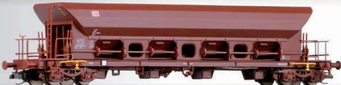
Selbstentladewagen Facs 124 der DB AG Hopper car Facs 124 of the DB AG
