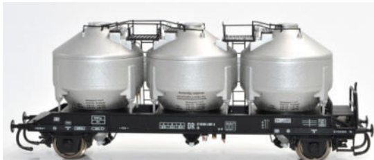
2-achsiger Silowagen Bauart Ud-y der DR (Epoche IV) zum Transport von Kunststoffgranulaten, 1. Betriebs-Nr. NW 22066 DC 2L H0 49,90 €
