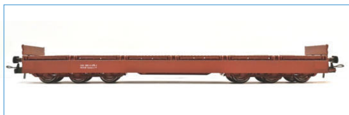
6-achsiger Schwerlastwagen Bauart Samms-u 454 der DB AG (Epoche V) braun, mit abgeklappten Bordwänden, unbeladen, 2. Betriebsnummer NW 22144 DC 2L H0 41,90 €
