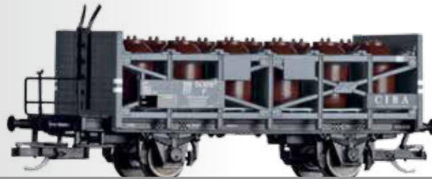
Säuretopfwagen P der CIBA AG, eingestellt bei den SBB Acid pot car P CIBA AG of the SBB
