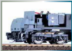
Entstörersatz eingebaut / Installed interference sup- pression set
