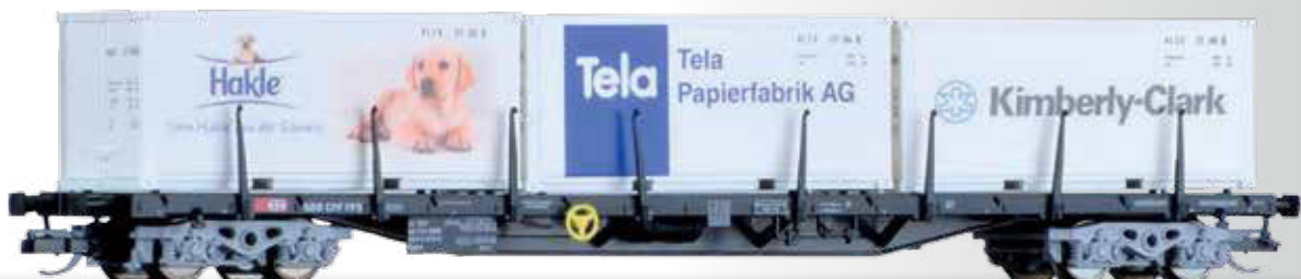
Containertragwagen Sgss der SBB, beladen mit drei 20' Containern Container car Sgss of the SBB with load
