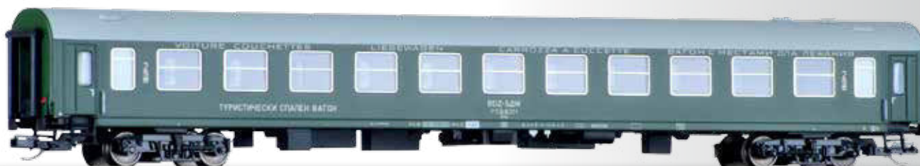
Liegewagen 2. Klasse Bcme, Bauart Halberstadt, der BDZ 2nd class couchette coach Bcme, type Halberstadt, of the BDZ
