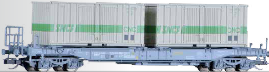
Taschenwagen „Novatrans“ der SNCF, beladen mit zwei 20' Containern Pocket wagon "Novatrans" of the SNCF with two 20' container
