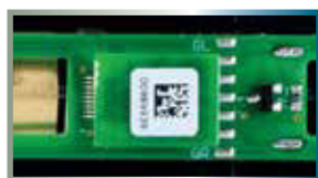
Entstörersatz eingebaut / Installed interference sup- pression set
