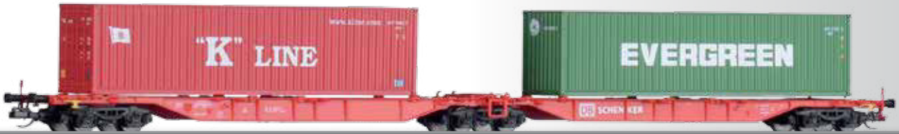
Doppeltragwagen Sggmrs der DB AG, beladen mit zwei 40'-Containern Container car Sggmrs of the DB AG with load
