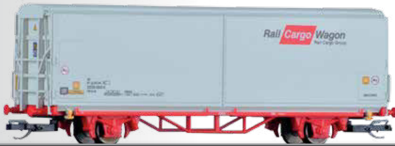
Schiebewandwagen Hbis-tt „RailCargoWagon“ der ÖBB Sliding wall box car Hbis-tt "RailCargoWagon" of the ÖBB
