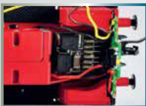
Entstörsatz eingebaut / Installed interference suppression set
