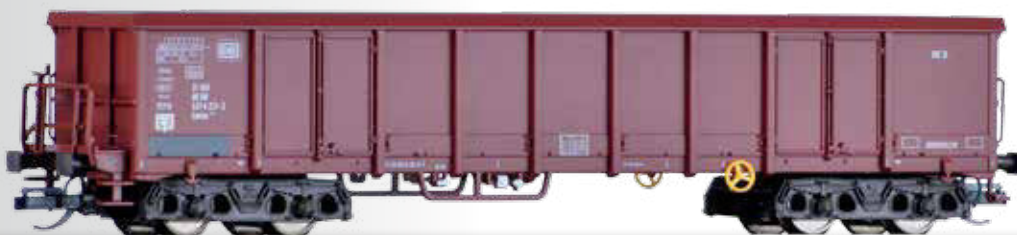
Offener Güterwagen Eanos 052 der DB Open car Eanos 052 of the DB • Mit Bremserbühne / With platform
