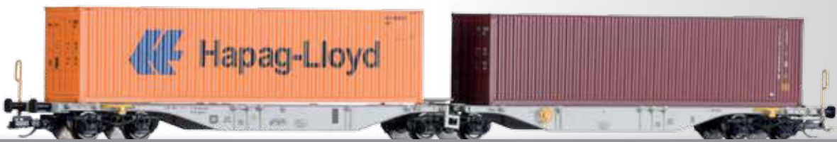
Containertragwagen Sggmrs 747 der DB AG, beladen mit zwei 40'-Containern Container car Sggmrs 747 of the DB AG with load
