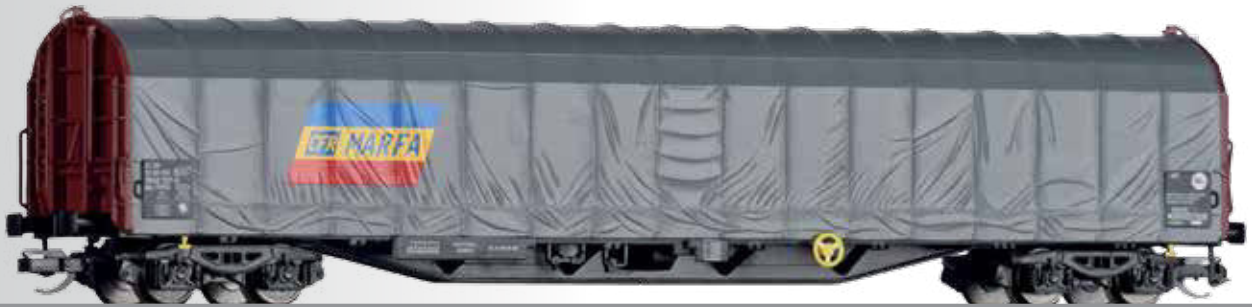
Schiebeplanenwagen Rils der CFR Marfa Sliding tarpaulin car Rils of the CFR Marfa
