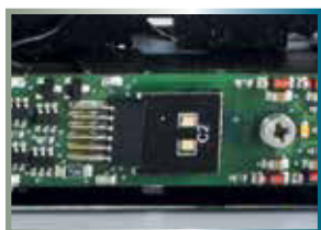
Entstörersatz eingebaut / Installed interference suppression set
