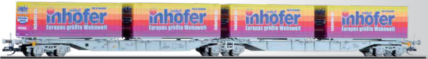
Doppeltragwagen Sggmrs 104 der AAE, beladen mit vier Wechselbehältern „Inhofer“
