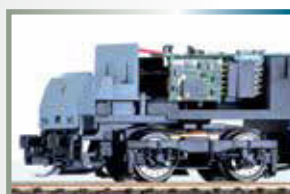
6-poliger Decoder eingebaut / Decoder 6 pole installed
