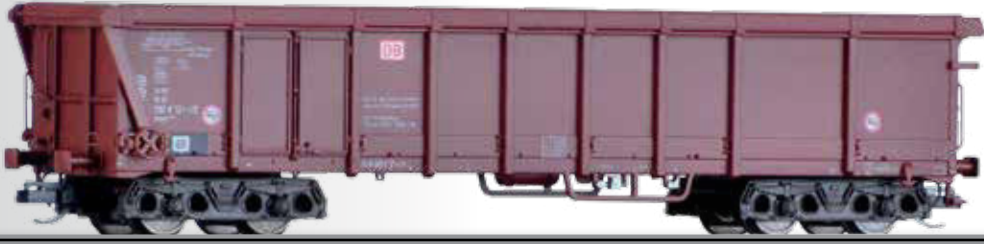
Rolldachwagen Tamns 893 der DB AG, vermietet an Berzelius Umwelt-Service Sliding roof car Tamns 893 of the DB AG
