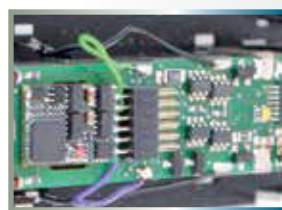
Decoder eingebaut / Installed decoder
