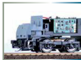
Decoder eingebaut / Installed decoder
