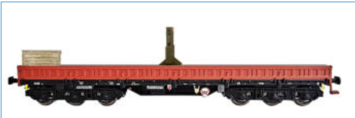
6-achsiger Kranschutzwagen Sas 4050 der DR (Epoche IV) braun-schwarz, mit Stütze für Kranausleger und Holzkiste für Werkzeug
